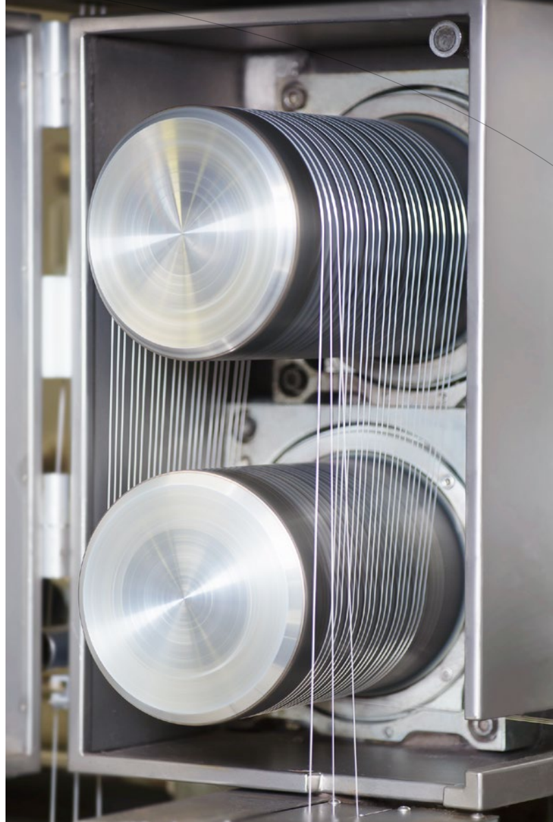
Induktives Heizen in der Kunstfaserherstellung. Bild © Oerlikon Neumag
