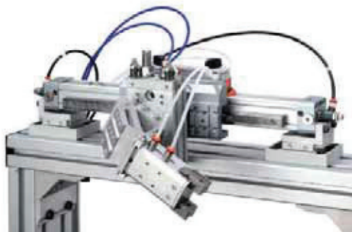
Die Vorteile des modularen V-Lock-Verbindungssystems von Metal Work kommen insbesondere in Montageanlagen zum Tragen.
